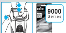
Po výměně kazety planžety a zastřihovače zmáčkněte alespoň na 3 sekundy pomocí kuličkového pera tlačítko «reset» ⑬, počítadlo se restartuje.
