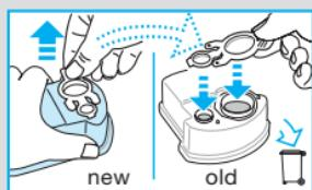
zdjętej z nowego wkładu, ponieważ zużyty wkład zawiera zanieczyszczony roztwór płynu czyszczącego.
