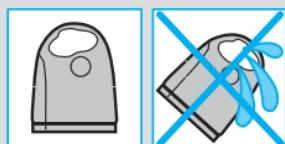
Enoto Clean&Renew vedno postavite na ravno in trdno površino, da preprečite morebitno iztekanje čistilne tekočine. Ko je nameščena čistilna kartuša, enote ne smete nagibati, hitro premakniti ali prenašati, saj v nasprotnem primeru čistilna tekočina lahko izteče iz kartuše. Prav tako sistema ne smete hraniti v omarici z ogledalom ali na zloščeni oz. lakirani površini.
