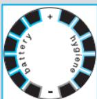
W lewej części wyświetlacza golarki (14) wyświetlany jest poziom naładowania akumulatora a w prawej poziom czystości golarki. (Gdy akumulator jest całkowicie naładowany a golarka jest czysta na wskaźnikach po obu stronach wyświetlacza widocznych jest 6 ciemnych segmentów).
