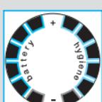
A borotva kijelző ⑭ a baloldalon mutatja az akkumulátor töltöttségi állapotát, és a jobb oldalon a higiéniai állapotot (6 db sötét szegmens mutatja minden oldalon, hogy az akkumulátor teljesen fel van töltve és a borotva megfelelő tisztaságú).
