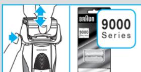
Ked' nadstavec s planžetou a žiletkami vymeníte, vynulujte displej strojčeka pomocou guľôčkového pera tak, že stlačíte tlačidlo na vynulovanie ⑯ aspoň na 3 sekundy. Indikátor pre výmenu dielov počas tohto úkonu svieti a vypne sa, keď sa vynulovanie dokončí. Manuálne vynulovanie môžete urobiť kedykoľvek.
