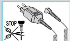
آلـةـ الـحـلـاقـةـ «Pulsonic» مزوـدةـ بـسـلـكـ خـاصـ مـعـهـزـ لمـصـدـرـ طـاـقـةـ ذـوـ فـوـلـتـيـةـ مـنـخـفـضـةـ لـدوـاعـيـ الـأـمـانـ. لاـ تـسـبـيـلـ أـوـ تـغـيـرـ أـيـ جـزـءـ مـنـ السـلـكـ لـأـنـ ذـلـكـ قدـ يـعـرـضـكـ لـخـطـرـ الصـدـمـةـ الـكـهـرـيـائـيـةـ.
