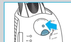
إذا اختار جهاز التنظيف أحد برامج التنظيف المطلوبة ، فلن يبدأ البرنامج بالعمل حتى تضغط على زر بدء التنظيف «start cleaning» ④ . للحصول على أفضل النتائج ننصح بالتنظيف بعد كل حلاقة.
