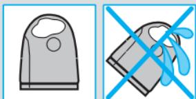
Во избежание утечки чистящей жидкости размещайте автоматическое устройство чистки и подзарядки Clean&Renew на плоской и устойчивой поверхности. Не допускайте опрокидывания, резкого перемещения или транспортировки устройства чистки и подзарядки Clean&Renew при установленном чистящем картридже. Не помещайте устройство чистки и подзарядки Clean&Renew в зеркальном шкафу, не ставьте на полированные или лакированные поверхности.
