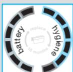
segmenten knipperen. Wanneer de accu volledig is opgeladen, zullen alle 6 de segmenten worden weergegeven. Bij het afnemen van de capaciteit van de accu zullen de segmenten geleidelijk verdwijnen.
