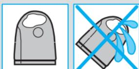
Sørg for, at Clean&Renew-stationen er placeret på en flad overflade for at forhindre lækage af rengøringsvæske. Når en rengøringspatron er sat i, må stationen ikke vippes, flyttes pludseligt eller transporteres, da rengøringsvæske derved kan løbe ud af patronen. Stationen må ikke placeres i et spejlskab, over en radiator eller på en poleret eller lakeret overflade.
