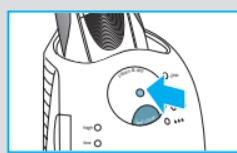
Mientras se efectúa la limpieza, el piloto correspondiente al programa de limpieza seleccionado parpadeará. Cada limpieza consta de varios ciclos de limpieza, durante los cuales el líquido limpiador actuará en el cabezal, y de una fase de secado. La duración total del proceso de limpieza oscila entre los 32 y 43 minutos.
