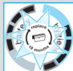
For at opnå optimal barbering hver gang bør kassetten med skæreblade og lamelknive ⑧ udskiftes, når udskiftningssymbolet ⑯ lyser (efter ca. 18 måneders brug), eller når kassetten er slidt.
