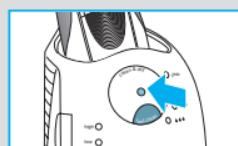
A luz indicadora do respectivo programa de limpeza seleccionado pisca durante todo o processo de limpeza. Cada programa de limpeza é constituído por vários ciclos, em que o líquido de limpeza envolve o interior da cabeça de corte e o período de secagem a quente seca a máquina. Dependendo do programa seleccionado, o tempo total de limpeza rondará entre os 32 e os 43 minutos.
