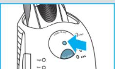
Hvis systemet har valgt én av de tre rengjøringsprogrammene, må du trykke på knappen («clean & dry») ④ for at rengjøringen skal starte. **For best mulig barberingsresultat, anbefaler vi rengjøring etter hver barbering.**
