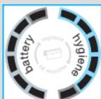
O visor da máquina de barbear <sup>16</sup> mostra no seu lado esquerdo o nível de carga da bateria, e no seu lado direito o nível de higiene. (Quando a bateria se encontra totalmente carregada, são visualizados 6 sinais escuros em ambos os lados e a máquina de barbear encontra-se limpa).
