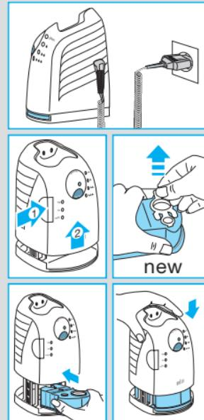
Temizleme sıvı göstergesi ① size kartuşun içinde ne kadar sıvı kaldığını gösterecektir.
