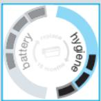
بعد تنظيف آلة الحلاقة في جهاز كلين آند رينيو، تظهر جميع دوائر النظافة الستة على الشاشة. ومع استخدام آلة الحلاقة، تختفي دوائر النظافة تدريجياً. وعندما توضع آلة الحلاقة في جهاز كلين آند رينيو مرة أخرى، يختار الجهاز برنامج التنظيف المناسب أوتوماتيكياً ويعيد دوائر النظافة إلى أقصى مستوياتها. ولأن غسل آلة الحلاقة تحت مياه الصنبور ليس صحيحاً مثل جهاز التنظيف، فإن دوائر النظافة لا تعود للظهور على الشاشة إلا في حالة تنظيف آلة الحلاقة داخل جهاز كلين آند رينيو.
