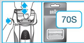
Potem ko zamenjate enoto z mrežico in rezili, s kemičnim svinčnikom za najmanj tri sekunde pritisnite na tipko za ponastavitev ⑯, da ponastavite števec.
