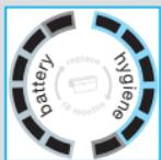
Wskaźniki naładowania i czystości golarki <sup>(16)</sup> pokazują stopień naładowania baterii po lewej i status czystości po prawej. (6 ciemnych segmentów oznacza w pełni naładowaną baterię oraz higieniczną czystość).
