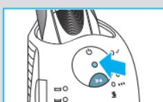
إذا اختار جهاز التنظيف أحد برامج التنظيف المطلوبة، فلن يبدا البرنامج بالعمل حتى تضغط على زر بدء التنظيف ④. للحصول على أفضل النتائج ننصح بالتنظيف بعد كل حلاقة.
