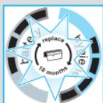
Symbol za zamjenu dijelova upozoravat će vas tijekom sljedećih 7 brijanja da trebate zamijeniti mrežicu i blok noža. Tada će se zaslon automatski resetirati.
