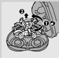
**1** Otvorte holiacu jednotku, zámkom otočte proti smeru pohybu hodinových ručičiek (1) a vyberte prítlačný rám (2).
