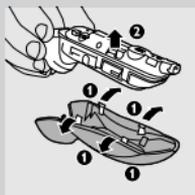
**4** Csavarja ki a motoregység három csavarját.
