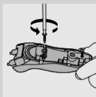
**6** Wyjmij moduł zasilający za pomocą śrubokrętu.
