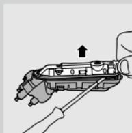
**5** Odegnij na boki 4 haczyki (1), aby wyjąć moduł zasilający (2).
