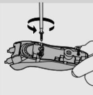
**6** Z izvijačem odstranite pokrov motorne enote.
