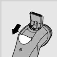
**1** Odprite rezilo s potiskom drsnika navzdol.
