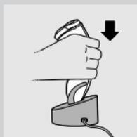
Přístroj je možné nabíjet také tak, že jej vložíte do nabíjecího podstavce (je-li přibalen).
