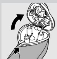
**1** Kapcsolja ki a borotvát, húzza ki a hálózati adaptert a fali aljzatból, majd a hálózati adapter csatlakozóját a borotvából.
