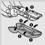
**4** Odkręć trzy śruby modułu zasilającego.
