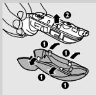
**4** Povolte tři šrouby v napájecí jednotce.
