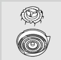
**2** Rezače a zdvíhače očistite dodanou kefkou. Nečistite viac ako jeden rezač a zdvíhač súčasne, nakoľko tvoria sadu. Ak ich omylom pomiešate, môže trvať niekoľko týždňov, kým opäť dosiahnu optimálny výkon.
