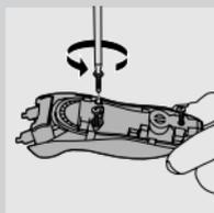
**6** С помощью отвертки снимите крышку блока питания.
