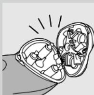
Ne szárítsa a borotvaegységet törülközővel vagy papírzsebkendővel, mivel ezek megsérthetik a körkéseket.
