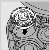
**3** Holiace hlavy vložte späť do holiacej jednotky. Prítlačný rám vložte späť do holiacej jednotky a zámkom otočte v smere pohybu hodinových ručičiek.
